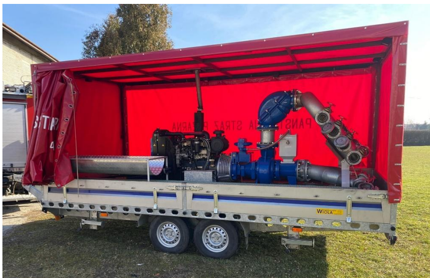
Przyczepa pompowa o wydajności 10,8 m 3 /min
