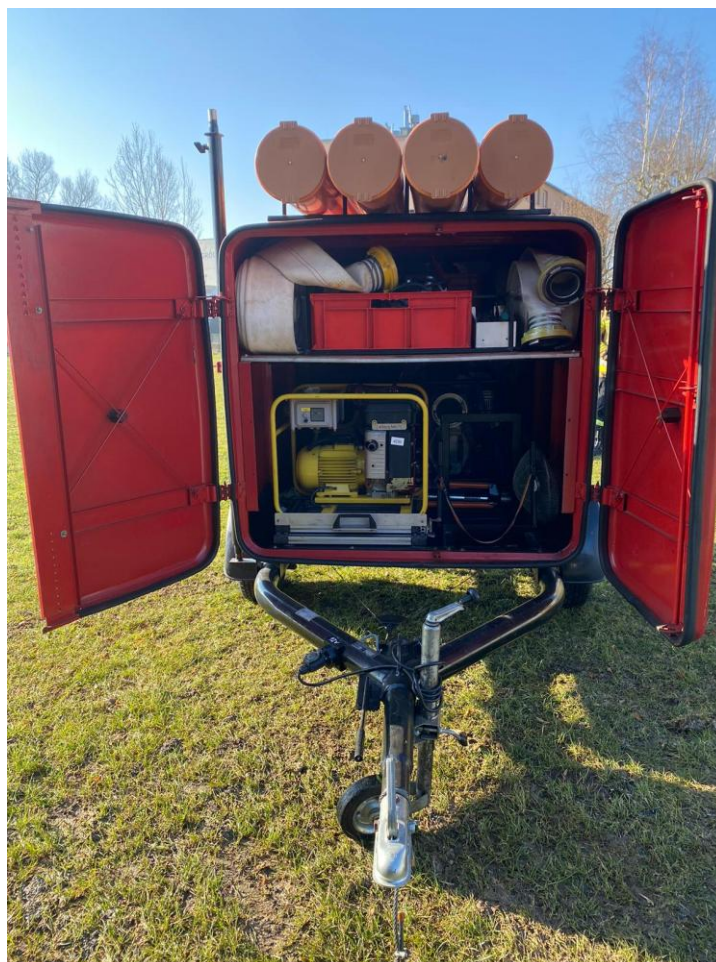
Przyczepa pompowa z 2 pompami WT 40X
