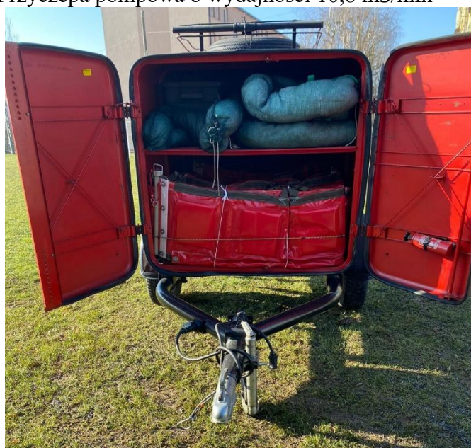
Przyczepa z zaporą przeciwolejąwą
