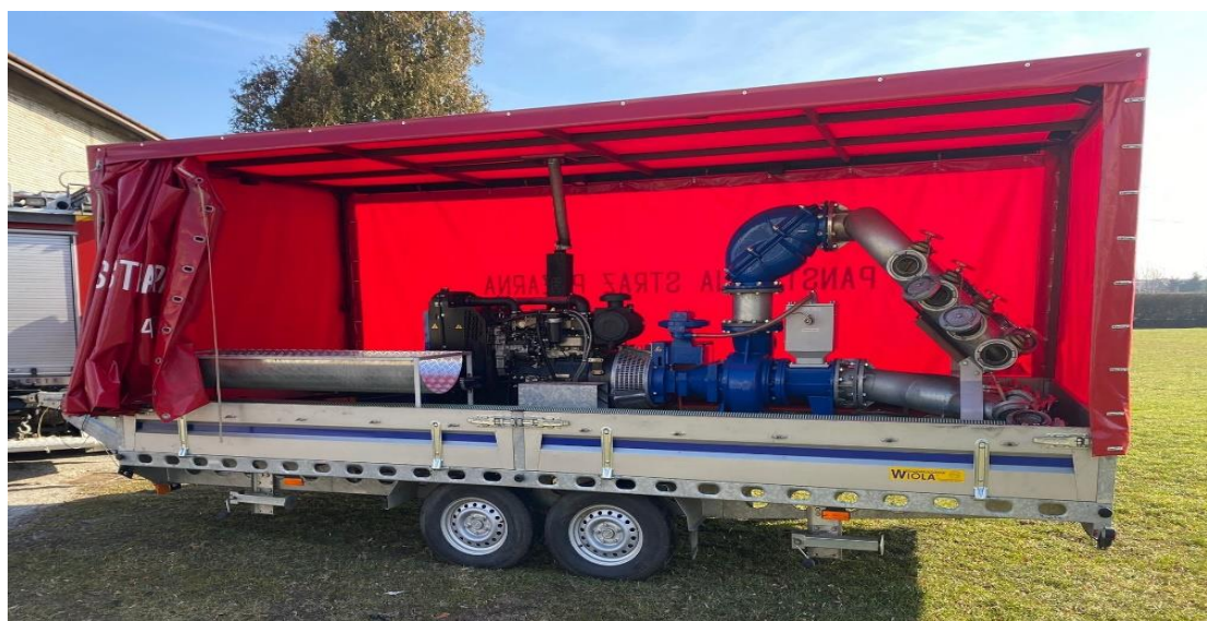
Przyczepa pompowa o wydajności 10,8 m 3 /min
